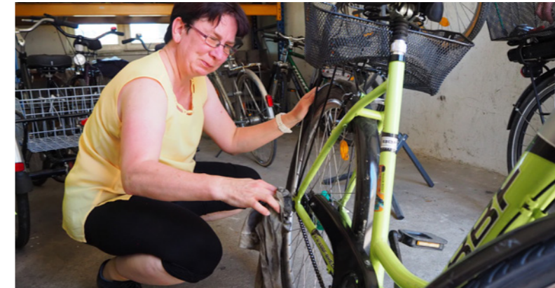
Die Pflege und Wartung der Fahrräder ist sehr wichtig. Nachdem die Kette geölt wurde, reinigt Mandy Wannowsky die Speichen. Gleichzeitig überprüft sie, ob alle Kabel und Drähte intakt sind.
