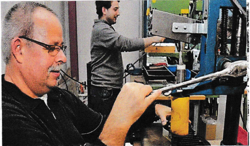
Heiko Simolka montiert Gewindebuchsen für die Sohlen von Spezialschuhen, die später Betonbauer tragen. FOTOS: RALF BADENSCHIER
